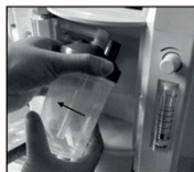
Рис. 62 – Извлечение увлажнителя и место наполнения его водой
