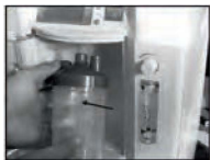
Рис. 49 – Расположение фильтра грубой очистки
