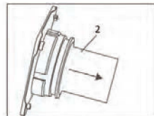
Рис. 6 – Порядок извлечения фильтра тонкой очистки, где:
