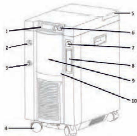
Рис. 59 – Внешний вид (вид спереди), где: 1 – дисплей; 2 – выход кислородно-воздушной смеси; 3 – выход для ингаляции (только для 7F-5EW); 4 – колесо; 5 – верхняя крышка; 6 – выключатель питания; 7 – регулятор скорости потока; 8 – индикатор скорости потока; 9 – увлажнитель; 10 – дверца увлажнителя.
