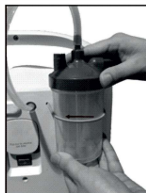
Рис. 35 – Извлечение увлажнителя и место наполнения его водой
